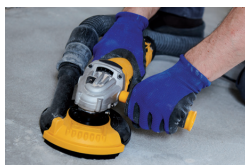
Machine équipée d'une aspiration
