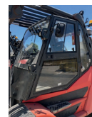
Engins équipés de cabine climatisée et pressurisée à air épuré
